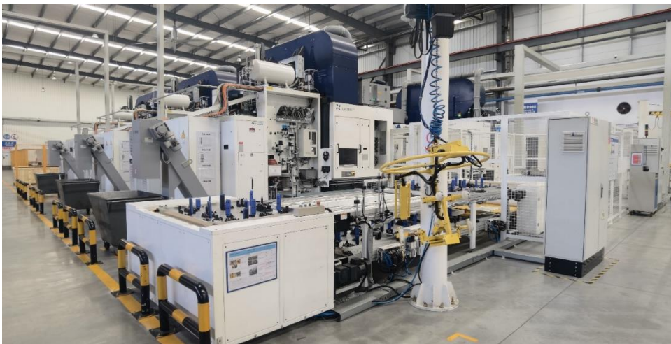
2023-07-17-Tuopu-4.jpg LiCON Bearbeitungszentrum für Hilfsrahmen in der Produktionshalle von Tuopu
