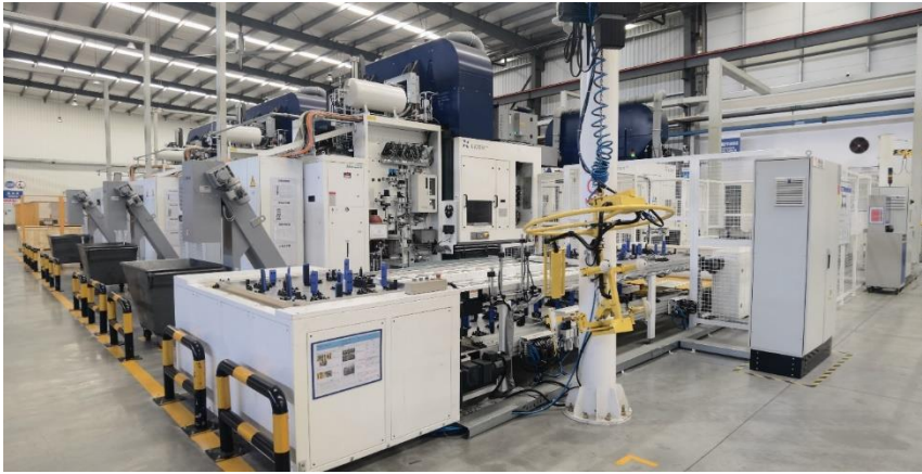
2023-07-17-Tuopu-4.jpg LiCON centro di lavorazione per sottotelai nel capannone di produzione di Tuopu
