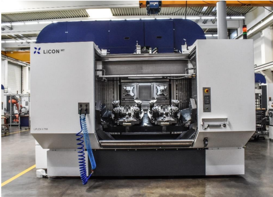
2023-06-09-Haldex-LiFLEX-II-766-i-DL-B2-Maschine.jpg Centro di lavoro bimandrino LiFLEX II 766 i DL B2
