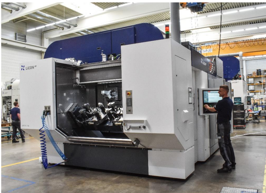
2023-06-09-Haldex-LiFLEX-II-766-i-DL-B2-Maschine+Bediener-1.jpg 双主轴加工中心 LiFLEX II 766 i DL B2 和操作员
