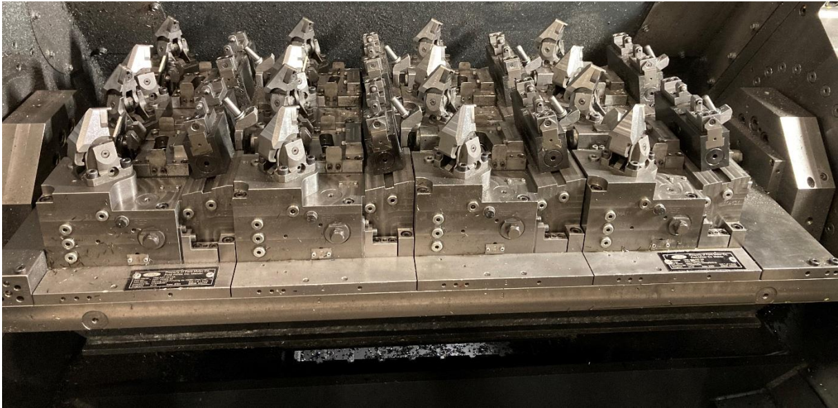
LiCON-Success-Story-Celikform-3.jpg Spannvorrichtung für Pkw-Türscharniere
