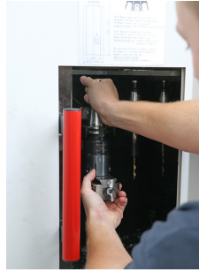
Bei Licon werden nur exakt voreingestellte Werkzeuge in die Bearbeitungszentren eingewechselt. (Bildnachweis: HAIMER)
