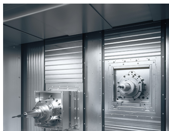
Die Licon i 3 -Technologie ermöglicht, dass beide Spindeln in allen drei Linearachsen (X, Y und Z) unabhängig korrigiert werden können. (Bildnachweis: Licon mt)
