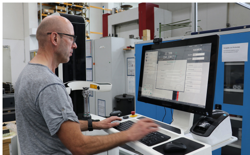
Fürs einfache Bedienen des Microset VIO linear sorgt die intuitive Hochleistungs-Software Microvision VIO. (Bildnachweis: HAIMER)
